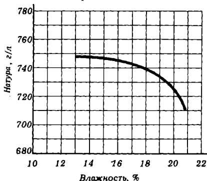
Рис. 7. Влияние влажности на натуру зерна пшеницы.
